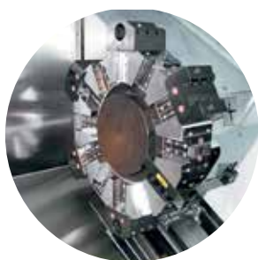
Револьверная гидравлическая голова
