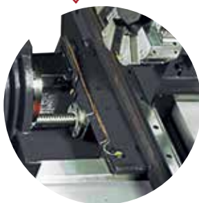
Высокоточные направляющие скольжения по осям X/Z в сочетании с ШВП
